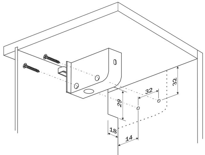
**1** Prepare a parede com as buchas e fixe as placas de sustentação. Utilize 2 parafusos AACC6.3X50
