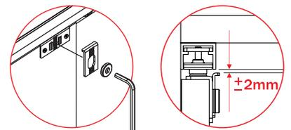
**1** Fixe as Guias Superiores e os Carrinhos Inferiores utilizando parafusos AACC3,9x16.
