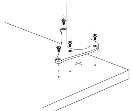
**1** Parafuse a base no tubo utilizando o parafuso M10x35mm.
