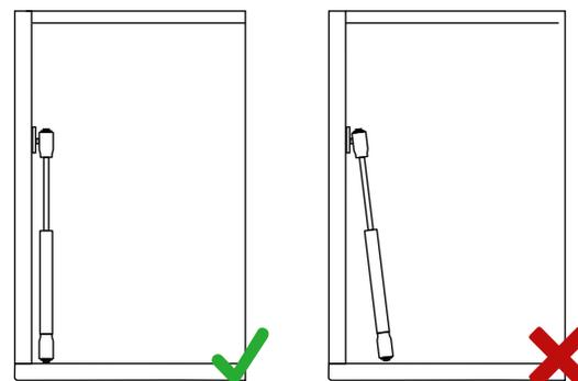
**!** O desalinhamento dos pontos de fixação faz com que a haste saia do eixo provocando atrito entre as partes e vazamento de gás e óleo.
