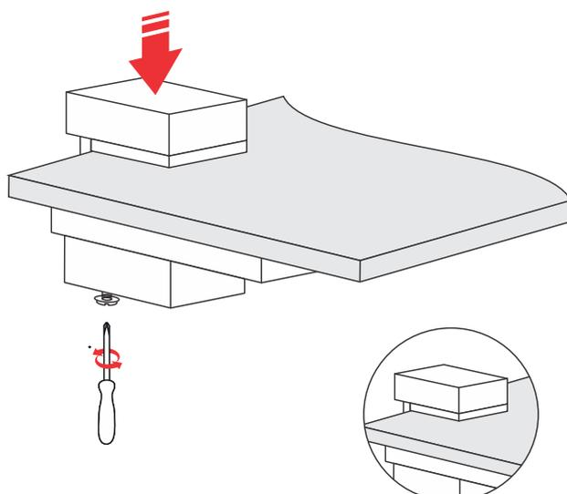
**1** Solte o parafuso de regulagem até obter acesso a furação de fixação da placa.
