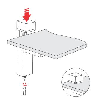
Posicione a prateleira sobre o Suporte e ajuste conforme a espessura.
