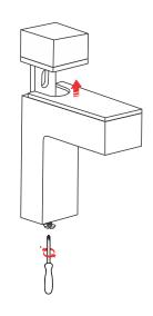
1 Solte o parafuso de regulagem até obter acesso a furação de fixação da placa.
