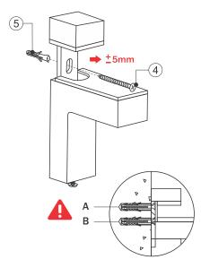
2 Fixe o Suporte utilizando o Parafuso e Bucha na posição A. Certifique-se do nível e então conclua a fixação.
