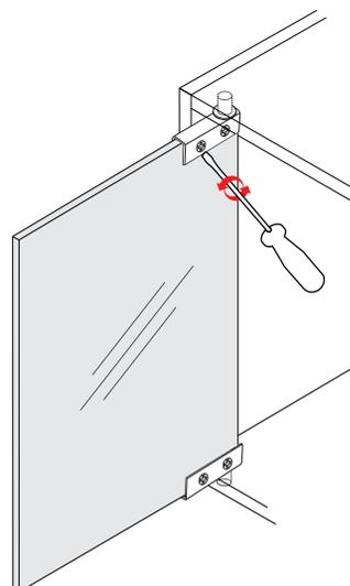
**1** Fixe as dobradiças na base superior e inferior do móvel em seguida encaixe o vidro.
