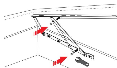
**3** Encaixe os pistões nos engates. Com o auxílio de uma chave de boca fixe as porcas M8.
