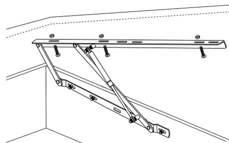
**2** Fixe o tampo no articulador utilizando os parafusos M6x30.
