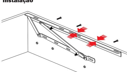
**1** Com o articulador fechado e alinhado na borda da cama, execute a fixação nas laterais utilizando os parafusos M6x30.
