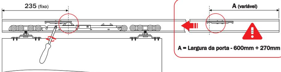
**4** Posicione e fixe as Placas Freio conforme as medidas indicadas.
