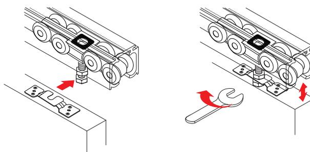
**6** Encaixe os Suportes nos parafusos dos Carrinhos e faça os ajustes necessários. ( Ambos os lados )
