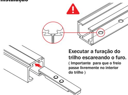
**1** Insira as Placas Freio no canal superior do trilho. ( A fixação será feita posteriormente )
