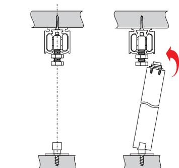
**5** Posicione a porta encaixando o canal inferior na Guia.
