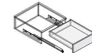
3 Em seguida puxar a gaveta para a frente, desencaixando - a da trava posterior.
