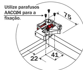
Utilize parafusos AACC04 para a fixação.
