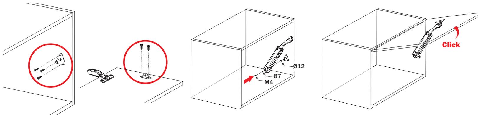
**1** Posicione as placas de fixação e fixe-as utilizando os parafusos Ø4x16mm.
