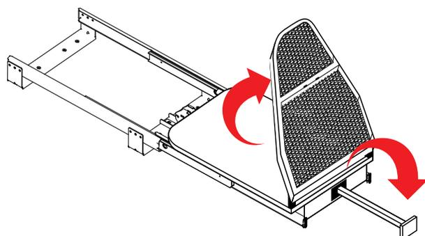
**4** Levante e encaixe a parte móvel da Tábua encaixando na trava plástica na extremidade da haste.
