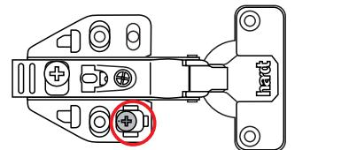
⚠ Posição 0 e 1 do parafuso são posições limites da regulagem. O giro além destes pontos causará o rompimento do sistema. ( anti-horário conforme posição do desenho )
