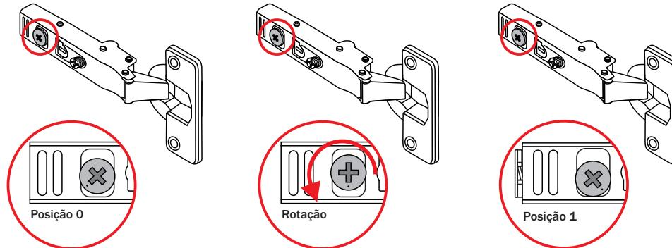
Para facilitar a montagem ( dobradiça / calço ) roteione suavemente o parafuso de regulagem de profundidade horizontal no sentido anti-horário, da posição 0 ( original ) até a posição 1.
