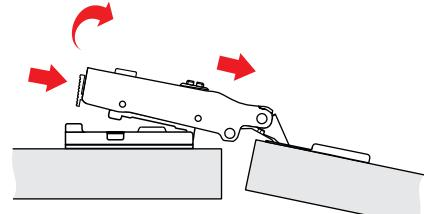
⚠ Para a desmontagem posicione o parafuso de regulagem horizontal na posição 0.
