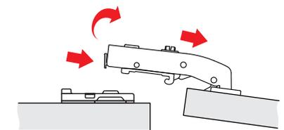
**!** Para a desmontagem posicione o parafuso de regulagem horizontal na posição 0.
