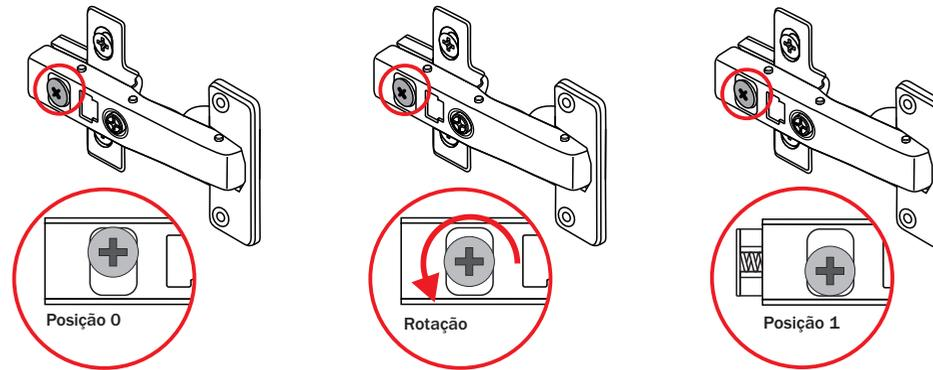
Para facilitar a montagem (dobradiça / calço) rotacione suavemente o parafuso de regulagem de profundidade horizontal no sentido anti-horário, da posição 0 ( original ) até a posição 1.
