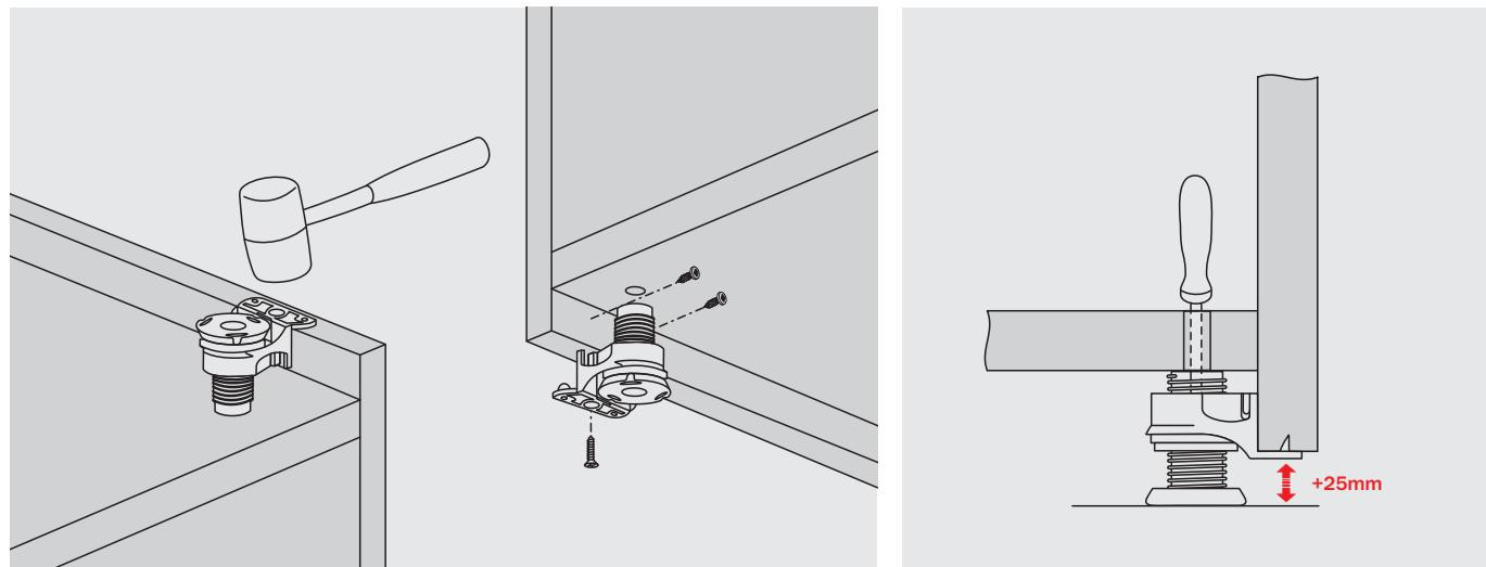
**9.0 Sapatas e Niveladores****Sapata Metálica com prego****Dados do Produto**
